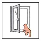
Wo Kleinkinder oder Personen mit geistiger Behinderung Zugang zum Fenster haben, ist der Flügel gegen Aufdrehen zu sichern, z. B. mit Drehsperre oder abschließbarem Bedienungsgriff.
