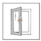
Der Fensterflügel darf nicht mit zusätzlichem Gewicht belastet werden.
